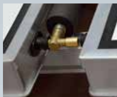
Glisser le deuxième capteur dans les raccords
